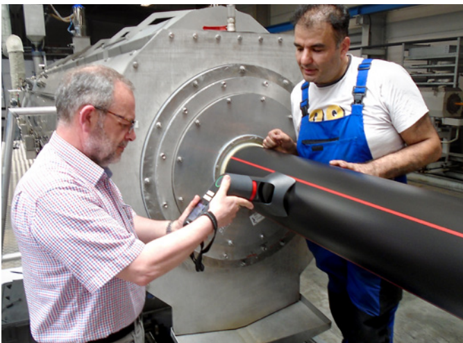
Stefan Depmer, Leiter für Technik und Betrieb, und Türkayan Güneyik, Betriebsleiter PE, überprüfen die Wanddicke während der laufenden Rohrextrusion.
